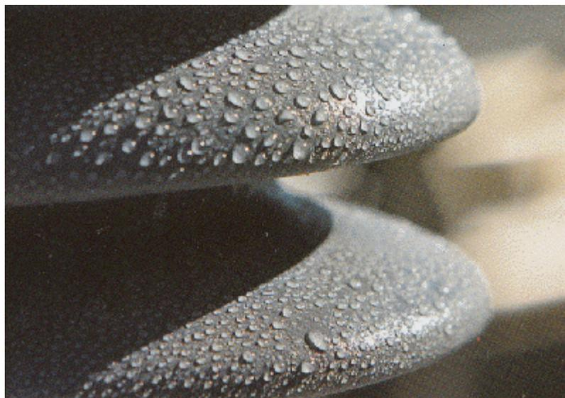
**Figura 1. 3.** Hidrofobicidad superficial en un aislador polimérico.
