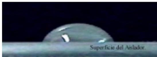
**Figura B. 3.** Ejemplo de la adquisición de una imagen de una gota de agua sobre la superficie del aislador.
